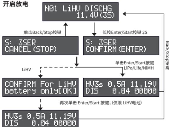
完成电池类型、工作模式、电池串数、电流等参数设置(参数设置操作详见1.1内容),确保设置的参数与实际电池一致;
