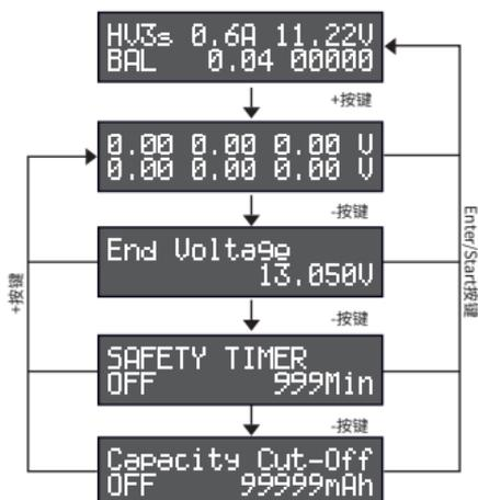
在充电/均衡/存储/放电任意模式工作时,点击“+”按键,查看当前电池的各单节电压;
