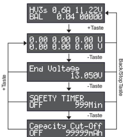
1 Wenn Sie im Charge (Laden); Discharge (Entladen), Storage (Lagern), Balance arbeiten, klicken Sie zum Anzeigen auf die „+“Taste, um aktuelle Einzelzellspannung der Batterie zu überprüfen;
