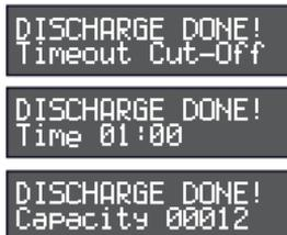
(3)Capacity Cut-Off模式放电完成界面
