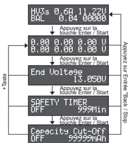
Lorsque vous travaillez dans le mode de charge avec équilibrage / équilibrage de cellule / stockage / décharge, appuyez sur la touche + pour vérifier la tension de chaque cellule
